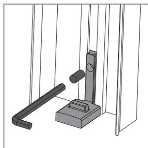
**7** Portare la baionetta inferiore con il profilo laterale e serrare con il grano.
