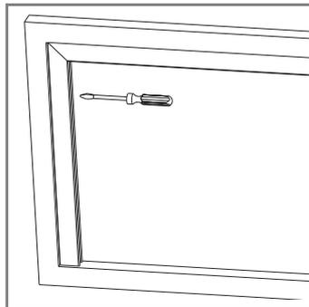
**6** Fissare i profili al vano (viti non in dotazione). N.B. il modello raffigurato è quello a guida bassa.
