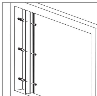
**9 (Solo per la versione con compensatore)** Forare e fissare i profili al vano. Regolare il profilo compensatore inserendo, nel foro apposito, un chiavino a brugola agendo sul registro già inserito nel profilo.
