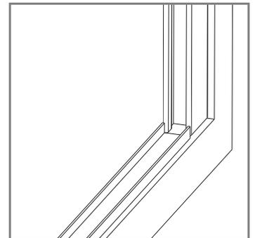
**8 (Solo per la versione a guida bassa)** Fissare il binario al vano in corrispondenza dei profili laterali.
